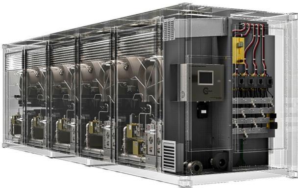
Der Lastbereich für den Erdgasbetrieb liegt zwischen 0 und 100 % der Nennleistung der jeweiligen Aggregate. Die Maschinen für erneuerbare Energien (Biogas, Klärgas, Deponiegas) können im Lastbereich 50 bis 100% betrieben werden. Die Schutzrelais sind integriert, d.h. die Mikrogasturbinen können direkt ans Netz angeschlossen werden. Die Turbinen können vom lokalen Display bedient werden, via RS232 Schnittstelle von einem externen PC/PLS, via Modem oder übers Internet.
